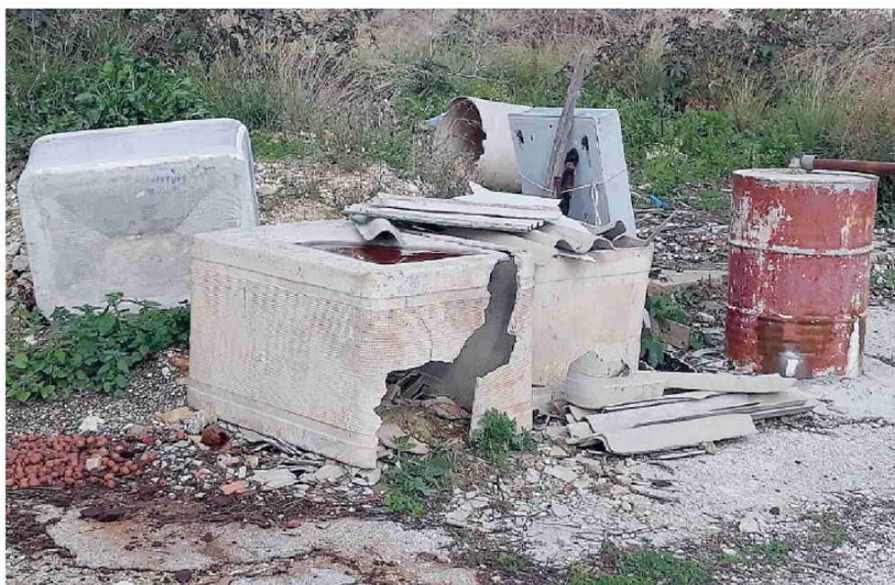
Pericoloso malcostume. Vasche di amianto abbandonate in una discarica abusiva
